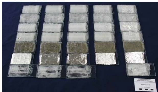
Laborversuchsreihen nach 100 Tagen Betestung mit der Materialkombination Cyclododecan/Paraloid B72.
